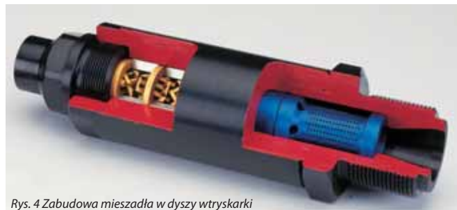
Rys. 4 Zabudowa mieszadła w dyszy wtryskarki
