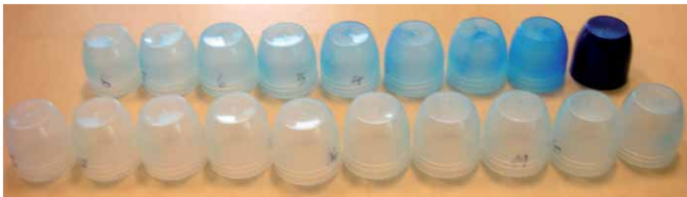
Rys. 10. Przejście z koloru granatowego na bezbarwny PP po 8 minutach (18 cykli). Materiał PP.
