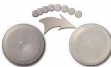
Rys.9 Przejście z koloru srebrnego do naturalnego po 10 cyklach. Materiał PP, forma 8-gniazdowa.
