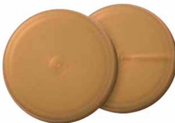
Rys11. Wtrysk przez nową końcówkę RC5. Wtrysk przez tradycyjną końcówkę RX.
