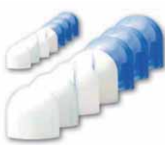
Rys. 8 Przejście z koloru niebieskiego na biały po 50 cyklach dzięki użyciu końcówki RC5 (przy zastosowaniu tradycyjnej końcówki zmiana nastąpiła po 120 cyklach). Materiał HDPE, forma 1-gniazdowa.
