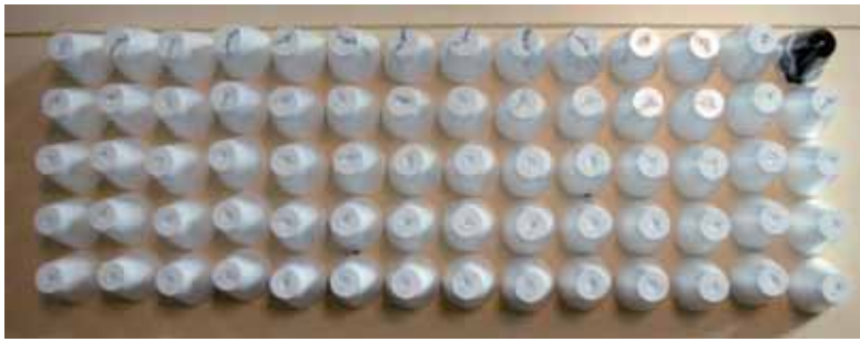
Rys. 3. Zmiana koloru przy zastosowaniu dyszy tradycyjnej (zmiana koloru z czarnego na biały, materiał PS)
