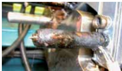
Rys. 9. Zalanie systemu tworzywem spowodowane uszkodzeniem uszczelnienia (styk tulejki centrującej z komorą) w obszarze przewężki dla dyszy Typ 2.
