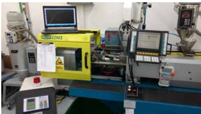
Rys. 4. Stanowisko na wtryskarce do testów i pomiaru temperatur badanych dysz.
